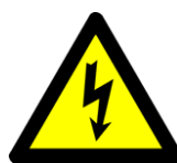
Gevaar voor elektrische spanning
